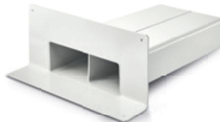
Der Speier mit rechtwinklig gebogenem Tablett ohne Schwelle gewährleistet den maximalen rückstaufreien Wasserabfluss. Für den direkten Einbau ohne Anstauhöhe<sup>3</sup>.
